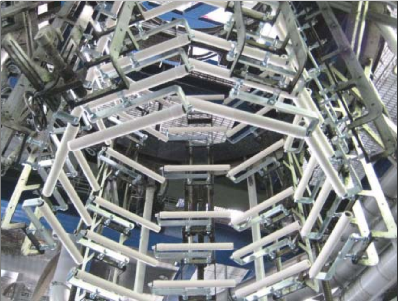
Esempio di trasformazione calibratore a forbice grandezza 2600 a 5 ripiani Example of conversion for scissor type calibration basket size 2600, 5 levels
